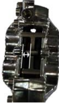
Figure 33 : mesure de l'étrier de frein
